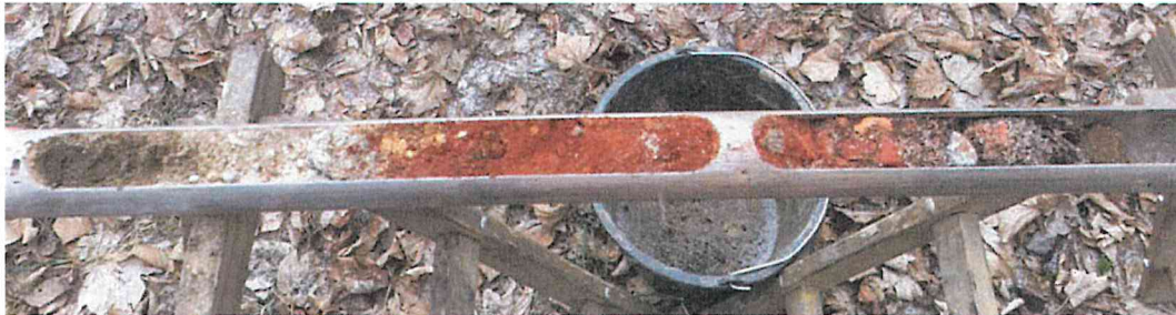
Abbildung 5 Bohrgut der KRB 2 (Teufbereich 0,0 - 1,5 m), Ziegelbruch.
