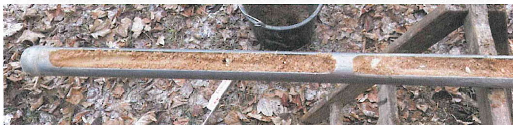
Abbildung 8 Bohrgut der KRB 6 (Teufbereich 1,5 - 3,0 m).
