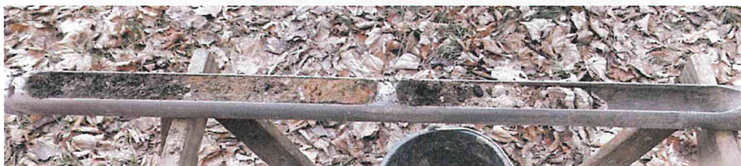
Abbildung 6 Bohrgut der KRB 3 (Teufbereich 0,0 - 1,5 m) Auffülle mit Kohleanteilen.
