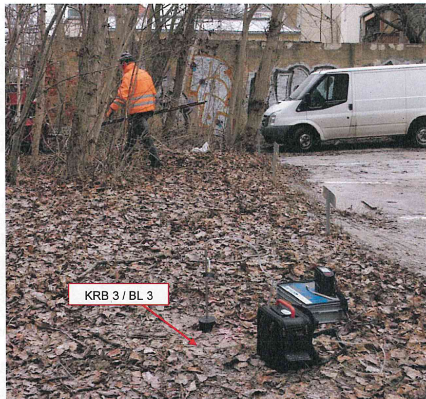
Abbildung 3 Bodenluftmessung am Bohrpunkt KRB 3 (BL 3), Blick Richtung Norden.
