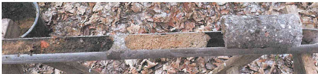
Abbildung 7 Bohrgut der KRB 5 (Teufbereich 0,0 - 2 m) Betonversiegelung mit Tragschicht und Auffülle.
